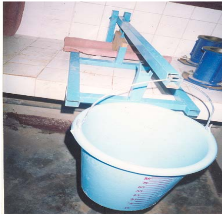
Figure 4 : Appareil de mesure de la charge maximale en flexion des tuiles
