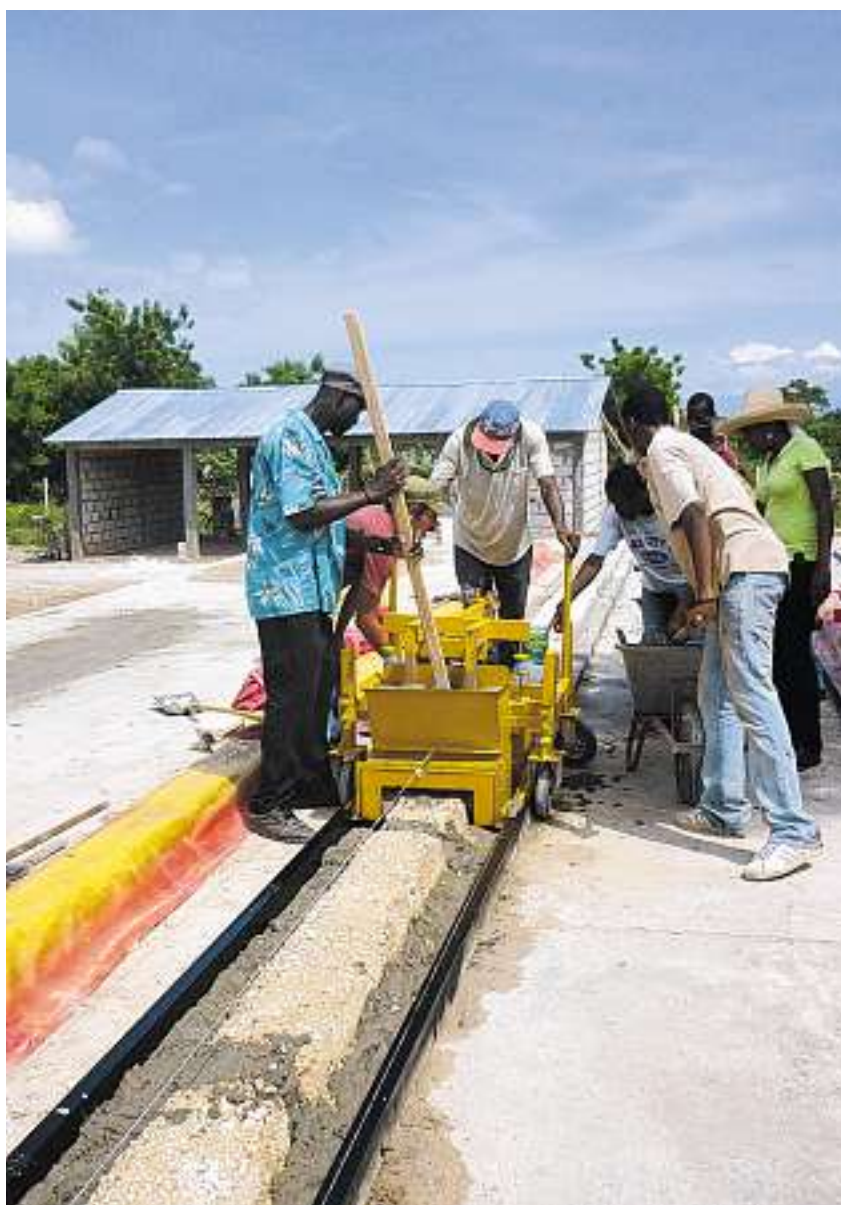
Ein Meter Wand- oder Deckenplatte pro Minute: Die Lehrlinge der Glarner Werkstätte in Liancourt, Haiti, wenden ihr Wissen handfest an.
