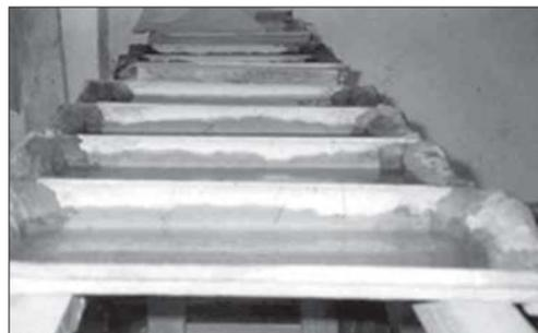
– Si una o más tejas ensayadas no presentan la impermeabilidad requerida, se debe chequear todo el proceso productivo, poniendo especial énfasis en la dosificación de la mezcla (relación agua-cemento) y el proceso de curado.
