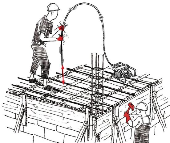
Compactar bien el hormigón con una aguja vibradora.
