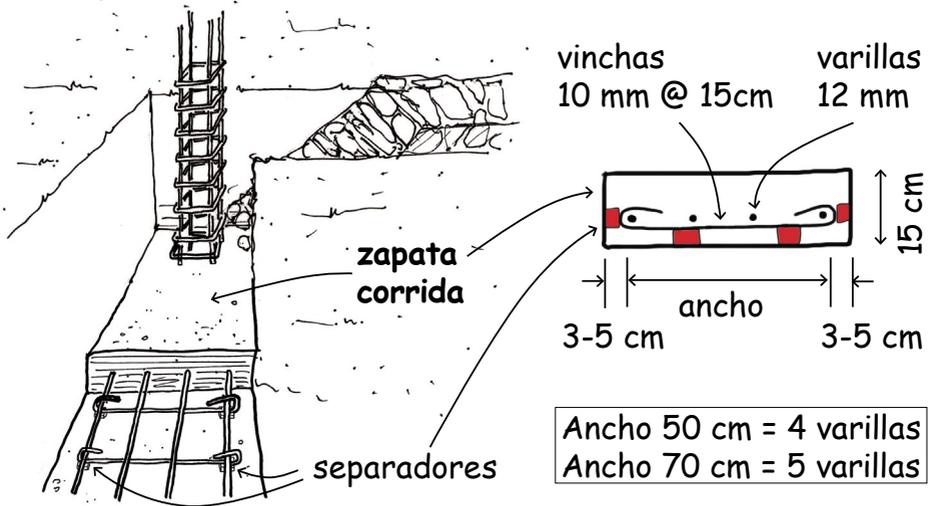
Antes de vaciar el concreto, asegura que las canastillas de las columnas de amarre estén perfectamente verticales.
