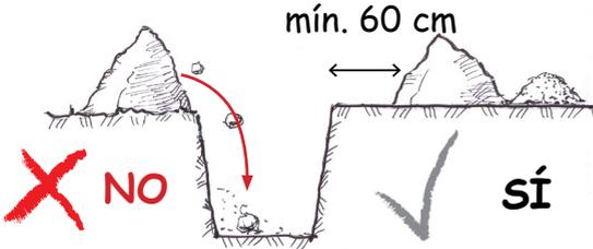
Poner el material excavado al menos a 60 cm de la zanja, para que no vuelva a caer produciéndose un derrumbe.
