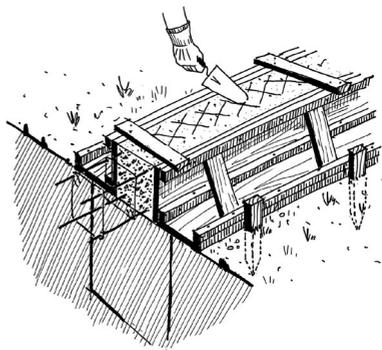
Dejar áspera la superficie de la viga de cimentación para aumentar la adherencia del mortero del muro.
