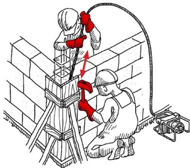
Vaciar el hormigón por capas de 30 - 50 cm y compactar bien con una varilla o mejor con una aguja vibratora.
