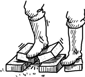
2. Resisten la "prueba de los 3 puntos" : colocar un ladrillo con sus bordes apoyados sobre otros dos, y subir sobre él. ¡ No debe romperse !
