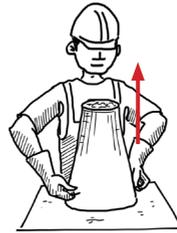
3. Levantar el cono verticalmente y colocarlo cerca de la mezcla.
