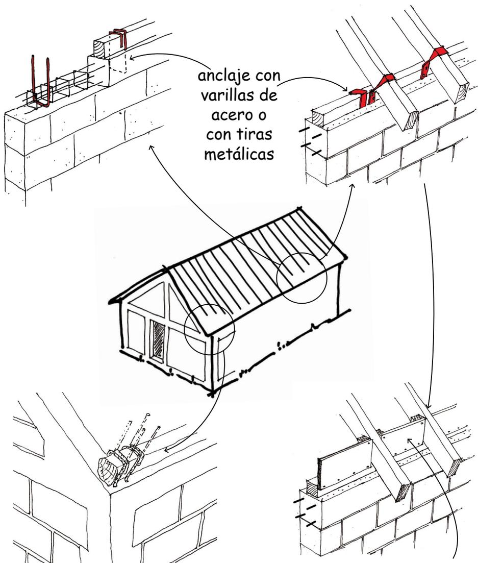
Sujetar firmemente las varillas o tiras a la estructura de madera.
