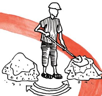
2. Mezclar el montón en seco, removiéndolo dos veces con la pala.
