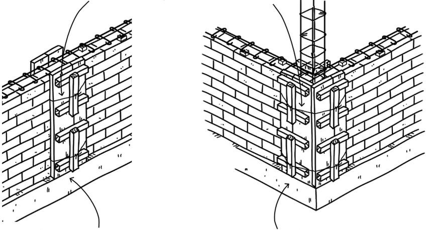
**Atención** : Esperar con este tipo de encofrado hasta que la mampostería y su mortero hayan endurecido sino los alambres moverán los ladrillos ó bloques.
