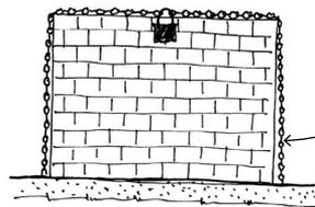
En la técnica de la mampostería confinada estas cadenas en hormigón armado se llaman **columnas de amarre** y **vigas de amarre**.
