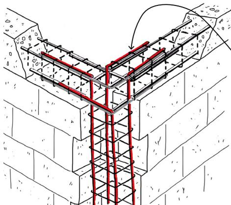
En el último piso, doblar las varillas de refuerzo vertical hacia la viga de losa.
