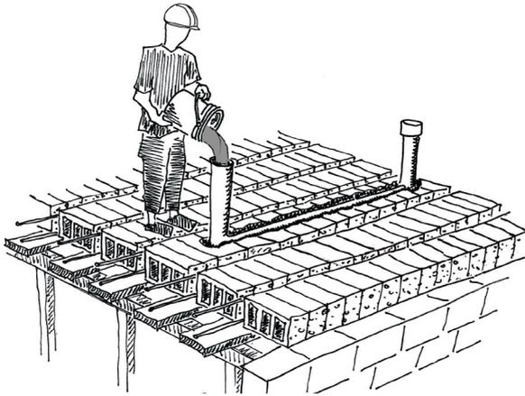
Para controlar la estanqueidad de las tuberías, llenarles con agua y esperar 4 horas para ver si las uniones de tubería estén secas. Vaciar el hormigón sólo después.
