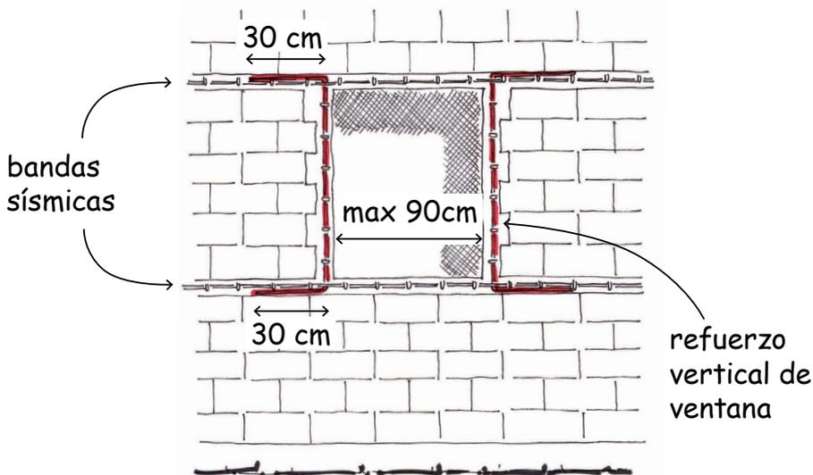
Amarrar las varillas verticales de refuerzo en las bandas sísmicas con los extremos doblados de 30 cm.
