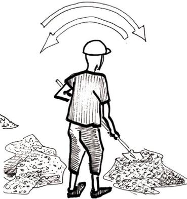
2. Mezclar el montón en seco, removiéndolo dos veces con la pala.
