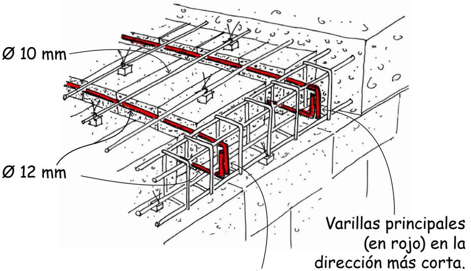
Para garantizar una buena conexión, los ganchos de la losa deben llegar hasta el lado exterior y dentro de la viga de amarre.
