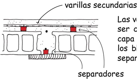
Las varillas secundarias deben ser colocadas en medio de la capa de hormigón que cubre los bloques huecos, utilizando separadores.
