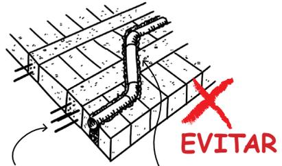
Pasar tubos a través de bloques y hormigón en un solo lugar. Al hacerlo, reforzar las viguetas con varillas adicionales.
