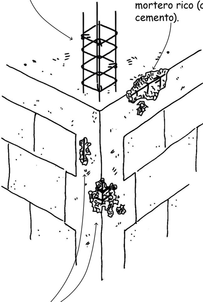
Cangrejas causadas por las burbujas de aire, debido a que la aguja vibradora fue sacada demasiado rápidamente.
