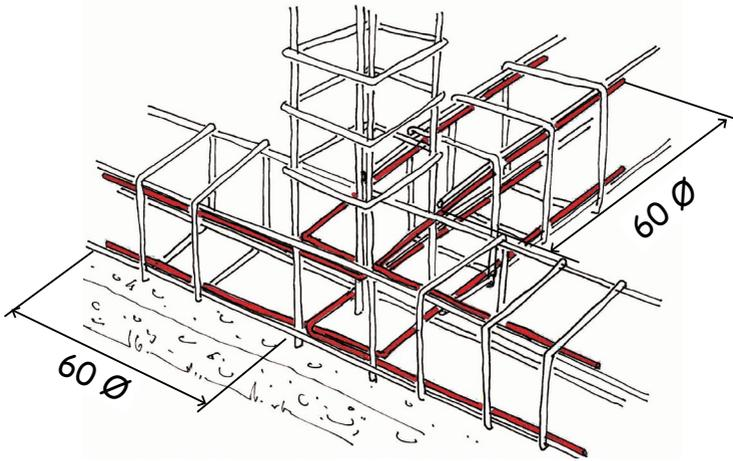
Los lados doblados de la varillas de conexión deben siempre ser colocados del lado exterior de la canastilla.
