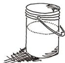
35 litros de agua limpia, o hasta poder hacer una bola con el hormigón.
