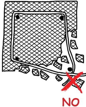
Estribo para columnas y vigas :
