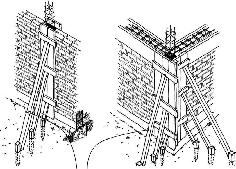
Encofrado fijado con puntales.
