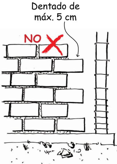
Si el dentado está más grande de 5 cm, el hormigón no puede penetrar correctamente en el dentado, y el peso del hormigón puede romper el dentado durante el vaciado.
